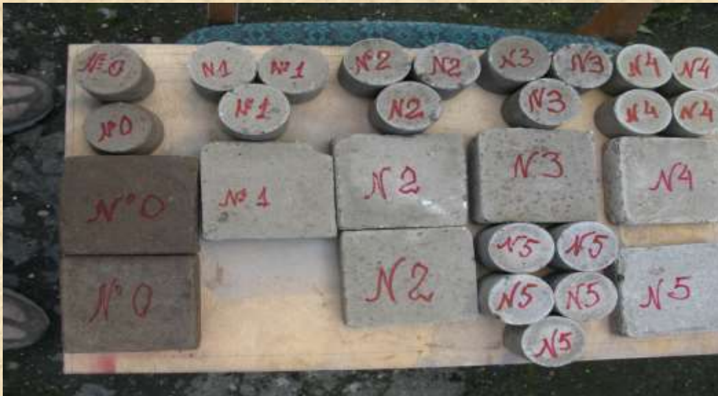
Образцы дорожных кернов для подбора дорожного покрытия в Новосибирске
